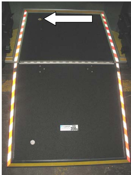
Rys. 20.3. Odchylona rampa – strzałką wskazano czujnik otwarcia rampy
