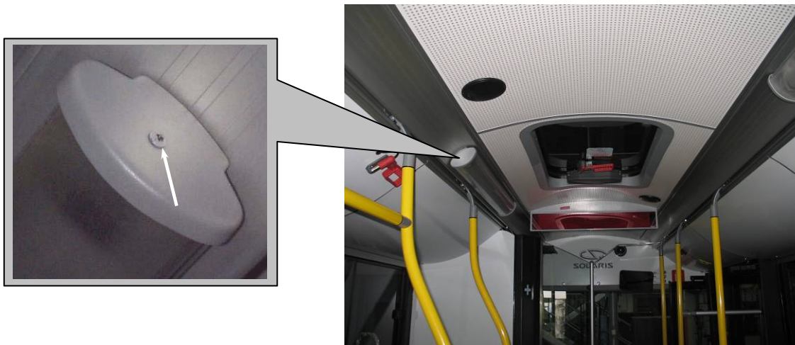
Rys. 15.21. Oświetlenie przedziału pasażerskiego – wkręt mocujący klosz lampy wskazany strzałką
