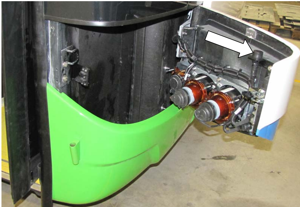
Rys. 15.30. Dostęp do przycisku otwierania 1-ch drzwi przez kierowcę z zewnątrz umiejscowiony w prawym skrzydle reflektorów (pokazany strzałką).
