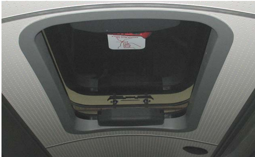
Rys. 21 Kłapa dachowa Happich jako wyjście awaryjne i kolejne etapy jej awaryjnego otwierania
