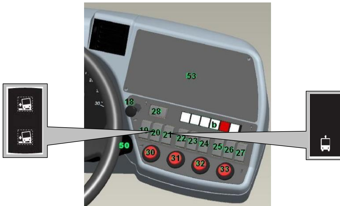
Rys. 10.2. Przyciski związane z zawieszeniem pneumatycznym; 20 – przyklęk, 21 - podnoszenie
