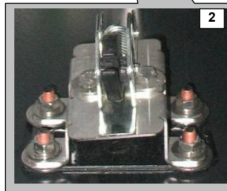
Rys. 15.28. Otwarta kłapa czołowa: 1 – prowadnica klapy, 2 – zatrzask klapy
