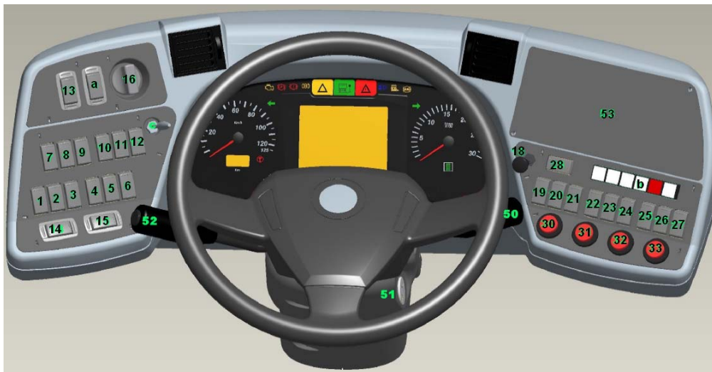
Rys. 5.1. Sterownik automatycznej skrzyni biegów : D – jazda do przodu, N – luz, R – jazda do tyłu (deska rozdzielcza kierowcy, poz. b)
