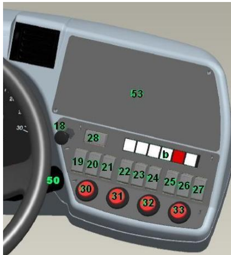
Rys. 7. Pulpit kierowcy – przycisk hamulca przystankowego (poz. 18)
